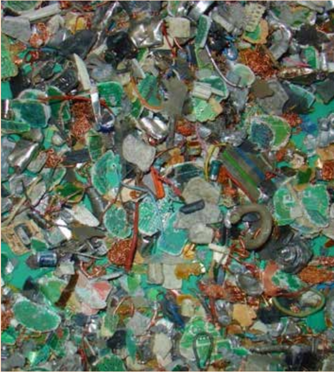
Bij Philips-Mirec werd afval van elektronica verwerkt, tegenwoordig Remondis. Dit beeld is het resultaat van het shredden (vermalen) van huishoudelijke apparaten zoals CD-spelers, videorecorders, telefoons, radio's.
